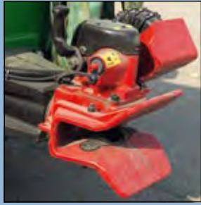
Ett VBG-drag har monterats bak på maskinen, som också försetts med luftkompressor för att manövrera draget och förse de kopplade släpen med tryckluft.
