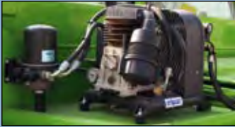
Ett VBG-drag har monterats bak på maskinen, som också försetts med luftkompressor för att manövrera draget och förse de kopplade släpen med tryckluft.
